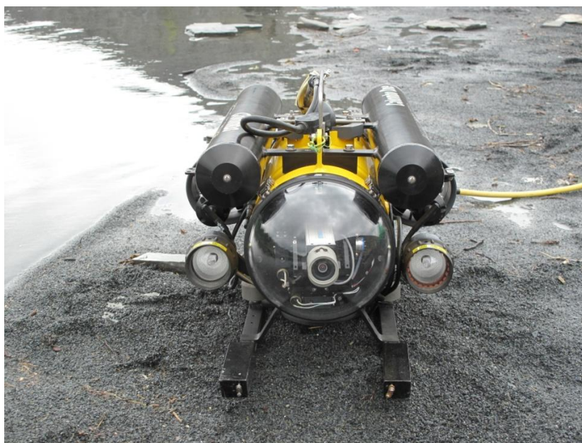
MINI Rover ponorka (kamera, dálkové ovládání)
